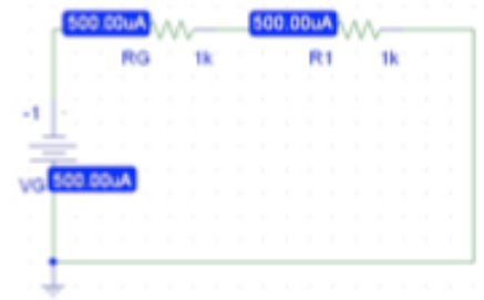
Figura II.6. Obtención de corrientes y tensiones DC por determinación del punto de polarización.
