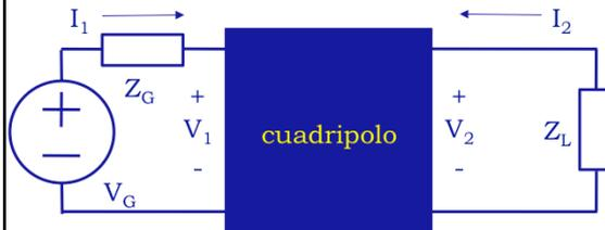
Circuito en régimen sinusoidal permanente a una frecuencia angular fija.
