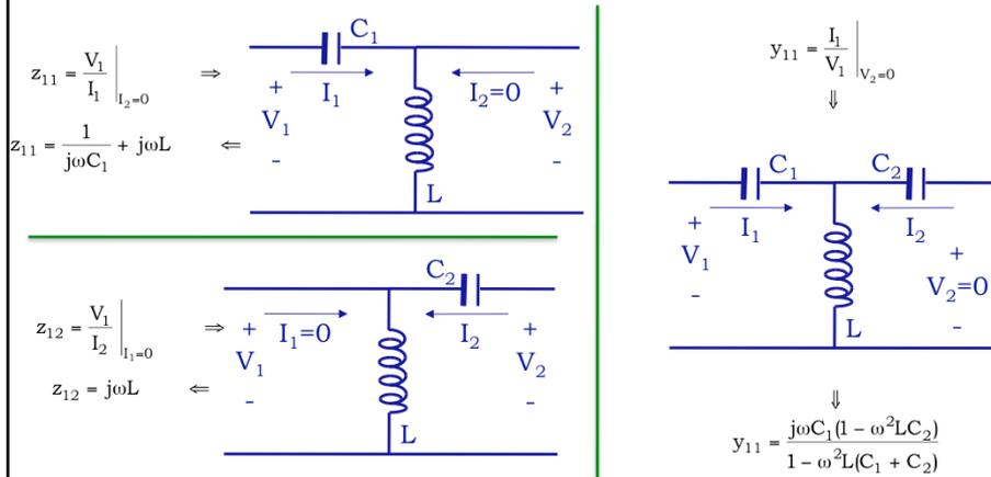
Para calcular  $y_{11}$  téngase en cuenta que la impedancia total del circuito en las condiciones en las que se define el parámetro es el paralelo de  $L$  y  $C_2$  en serie con  $C_1$  y que la admitancia total es el inverso de dicha impedancia total.
