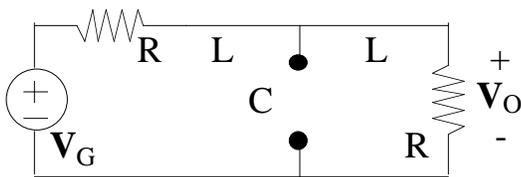
Para frecuencias muy bajas, las inductancias y las capacidades se comportan aproximadamente como cortocircuitos y circuitos abiertos, respectivamente, con lo que el circuito queda como se indica en la figura adjunta, a partir de la cual puede deducirse
