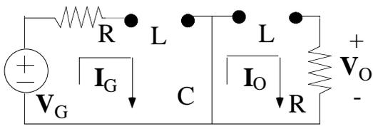
Para frecuencias muy altas, las inductancias y las capacidades se comportan aproximadamente como circuitos abiertos y cortocircuitos, respectivamente, con lo que el circuito queda como se indica en la figura adjunta, a partir de la cual puede deducirse
