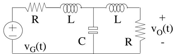
El circuito de la figura funciona en régimen sinusoidal permanente.
