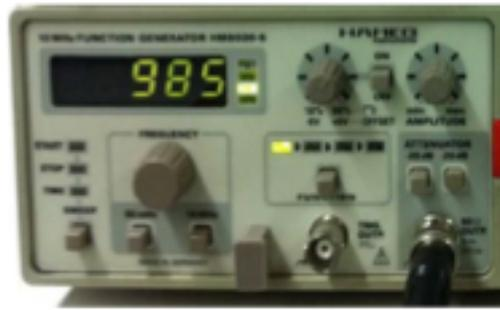
Figura I.10. Panel frontal del generador de señal Hameg hm8030.
