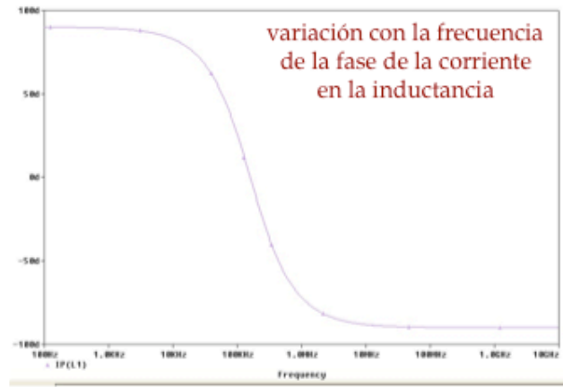
Figura V.1. Procedimiento para analizar con PSpice la respuesta en frecuencia de un circuito.
