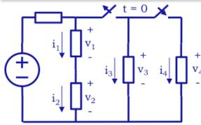
El circuito de la figura funciona en régimen permanente continuo. Se desea averiguar la naturaleza de los elementos a partir de los resultados indicados.
