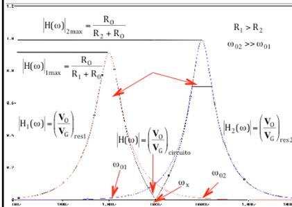
$$\omega \ll \omega_x \Rightarrow Z_1 // Z_2 \approx Z_1 \Rightarrow |H(\omega)| \rightarrow \frac{R_O}{|Z_1 + R_O|} = |H_1(\omega)|$$
