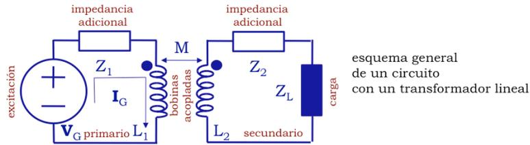
El esquema general puede hacerse equivalente al circuito de la figura inferior, en el que  $I_G$  tiene el mismo valor en ambos casos.
