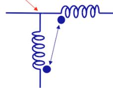
Obsérvese que el transformador lineal no permite el paso de excitación continua desde el primario hacia el secundario.
