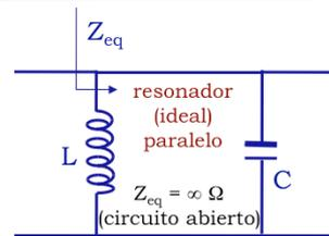
La variación del comportamiento de un circuito con la frecuencia de operación se debe a que las impedancias de los elementos reactivos cambian con aquélla. Un circuito compuesto exclusivamente por resistencias se comporta igual a cualquier frecuencia, ya que las impedancias de tales elementos son invariables.
