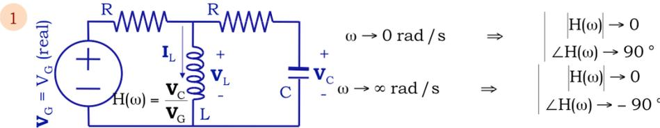
Los cálculos pedidos pueden ser efectuados analizando los circuitos por mallas y obteniendo en cada caso la tensión en la salida, pero es más sencillo (y tiene más sentido físico) realizarlos como se indica seguidamente.
