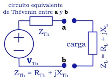
Si  $Z_L = Z_{Th}^*$  ( $R_L = R_{Th}$ ,  $X_L = -X_{Th}$ ) la potencia media en la carga es la máxima posible y vale
