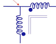
La reflexión de impedancias sirve para simplificar los cálculos en determinadas situaciones. La fórmula para obtener la impedancia reflejada es independiente de las posiciones de los puntos en las bobinas que definen el transformador. Puede reflejarse la impedancia del primario en el secundario (prescindiendo de la fuente como se indicará más adelante) como  $Z_R = a^2 Z_P$ .
