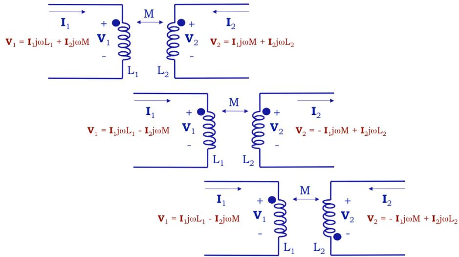
Las dos bobinas que participan conjuntamente en un fenómeno de inducción mutua se denotan mediante una fecha de doble sentido, a la que acompaña la indicación del valor del coeficiente de inducción mutua.
