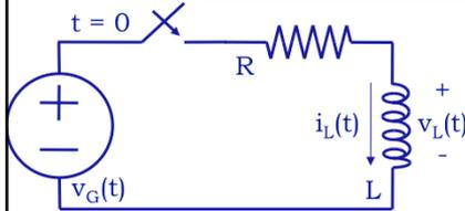
Ecuación del circuito :  $v_G(t) = Ri_L(t) + v_L(t)$
