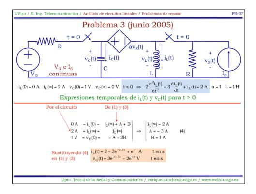
De no ser datos las condiciones iniciales y finales habría que obtener sus valores, para utilizarlos en (4), a partir del examen del circuito, y ello teniendo en cuenta los valores de las fuentes y los elementos pasivos.
