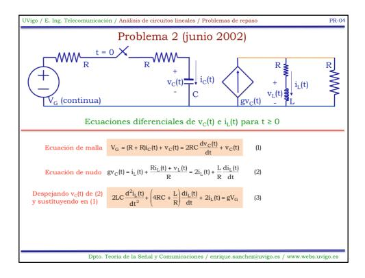
Obsérvese que se trata de un circuito con elementos parcialmente acoplados. Lo que ocurre en la capacidad es completamente independiente de lo que sucede en la inductancia; sin embargo, el comportamiento de ésta se encuentra influido por el de la capacidad a través de la fuente dependiente.
