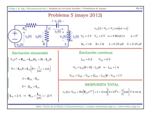
Obsérvese que es la propia definición de  $v_{\rm G}(t)$  la que indica que el circuito está sometido simultáneamente a dos excitaciones de distinta naturaleza, por lo que el problema ha de ser resuelto aplicando el principio de superposición.
