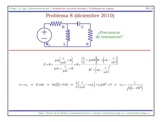
Obsérvese que la frecuencia de resonancia sólo existe efectivamente si L>CR<sup>2</sup>. Si no se cumple esta condición puede decirse que no hay ninguna frecuencia para la que el circuito tenga una impedancia puramente resistiva.
