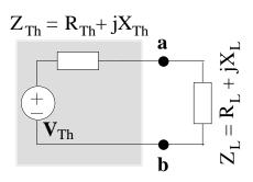
A un circuito caracterizado por su equivalente Thèvenin se le conecta una carga  $\mathbf{Z}_{\mathbf{L}}$ .
