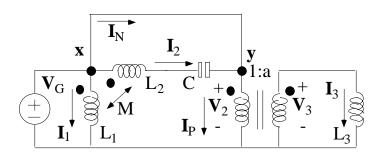
Obsérvese que el cortocircuito no cancela los elementos con los que está en paralelo. Ello se debe al efecto de inducción mutua de L<sub>1</sub> en L<sub>2</sub>; genera una tensión, que origina una corriente no nula.
