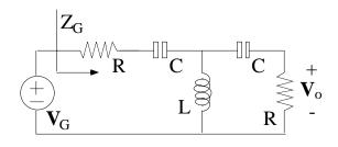
El circuito de la figura, en cuya representación se ha utilizado notación fasorial, funciona en régimen sinusoidal permanente. Son datos las características de todos los elementos.
