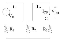
En continua el circuito queda en la forma indicada en la figura adjunta (las inductancias y las capacidades son cortocircuitos y circuitos abiertos, respectivamente).
