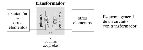
Un transformador modifica las condiciones en las que una excitación afecta a una carga (conjunto de elementos pasivos) con relación a las que existen en ausencia de aquél.
