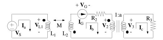
El circuito de la figura, en cuya representación se ha utilizado notación fasorial, funciona en régimen sinusoidal permanente.
