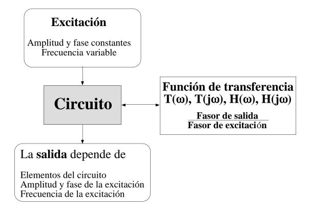
La dependencia del comportamiento de un circuito de la frecuencia de la excitación (comportamiento tipo filtro) es una de las bases de la tecnología de telecomunicaciones.
