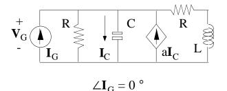
El circuito de la figura, en cuya representación se ha utilizado notación fasorial, funciona en régimen sinusoidal permanente.
