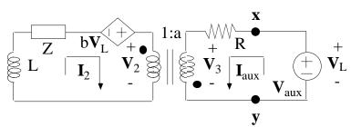
La desactivación de la fuente de corriente (sustitución por un circuito abierto) hace que no circule corriente por el primario del transformador lineal, con lo que no hay efectos de inducción mutua en éste.
