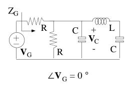
El circuito de la figura, en cuya representación se ha utilizado notación fasorial, funciona en régimen sinusoidal permanente. Son datos las características de todos los elementos. Se desea obtener la impedancia que ve la fuente, y los valores a los que tienden el módulo y la fase de  $V_C$  cuando ω tiende a 0 rad/s y cuando ω tiende a  $\infty$  rad/s.
