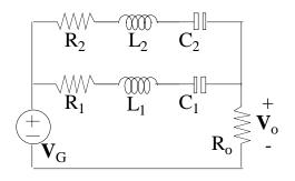
Se desea obtener una representación cualitativa de la variación del módulo de la función de transferencia con la frecuencia.
