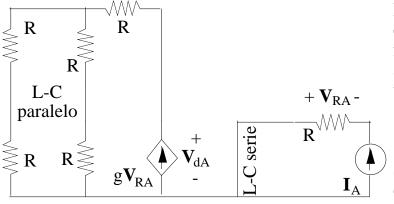
Bajo excitación sinusoidal el circuito queda en la forma indicada en la figura adjunta, en la que se ha utilizado notación fasorial.
