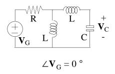
El circuito de la figura, en cuya representación se ha utilizado notación fasorial, funciona en régimen sinusoidal permanente. Son datos las características de todos los elementos del circuito. Se desea obtener los valores a los que tienden el módulo y la fase de  $V_C$  cuando  $\omega$  tiende a 0 rad/s y cuando  $\omega$  tiende a  $\infty$  rad/s, y el valor de la frecuencia de resonancia del circuito.
