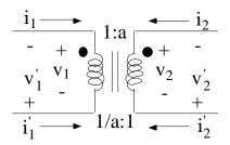
El transformador ideal se denota con dos rayas entre las bobinas, e indicando la relación de transformación (en cualquiera de las dos formas mostradas en la figura)
