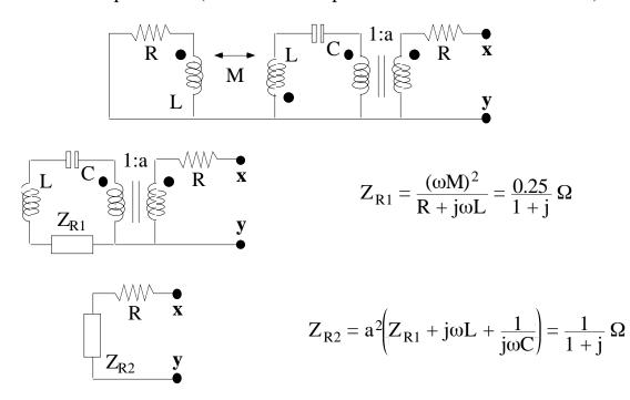
La reflexión de impedancias en el transformador lineal es simétrica; en el ideal, no
